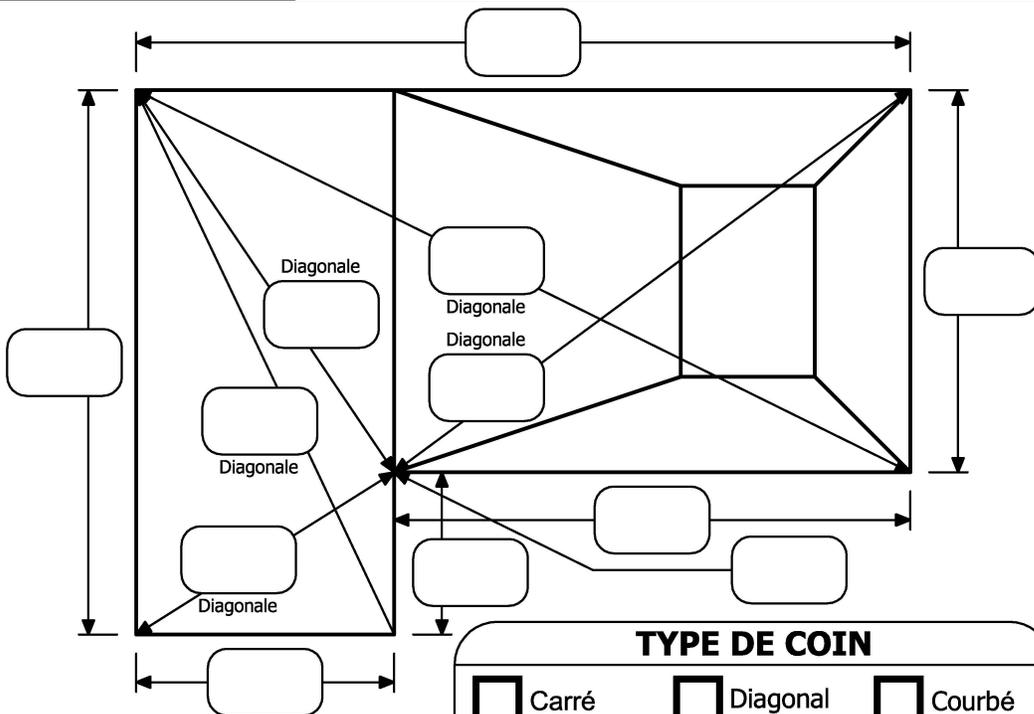
**Note :** La diagonale doit être mesurée à partir du coin à 90°
