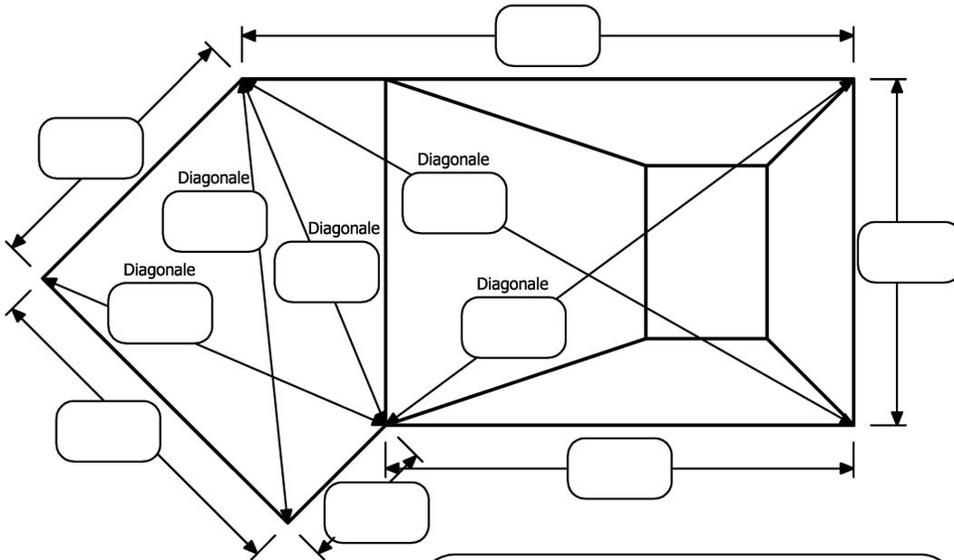
**Note :** La diagonale doit être mesurée à partir du coin à 90°
