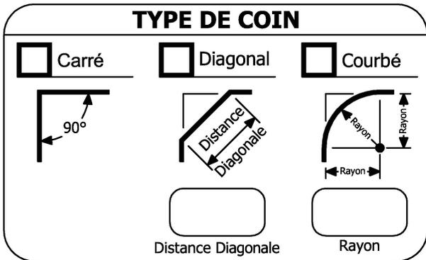
**Note :** La diagonale doit être mesurée à partir du coin à 90°
