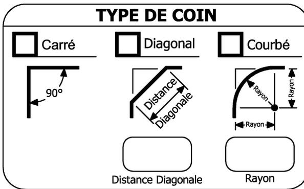
**Note :** La diagonale doit être mesurée à partir du coin à 90°
