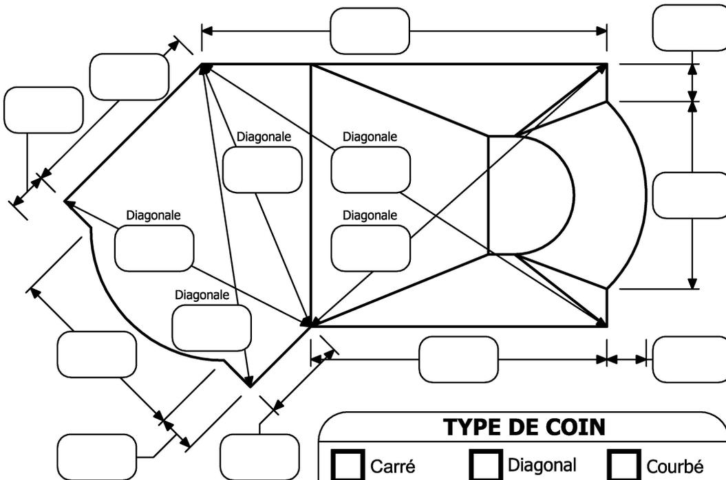
**Note :** La diagonale doit être mesurée à partir du coin à 90°
